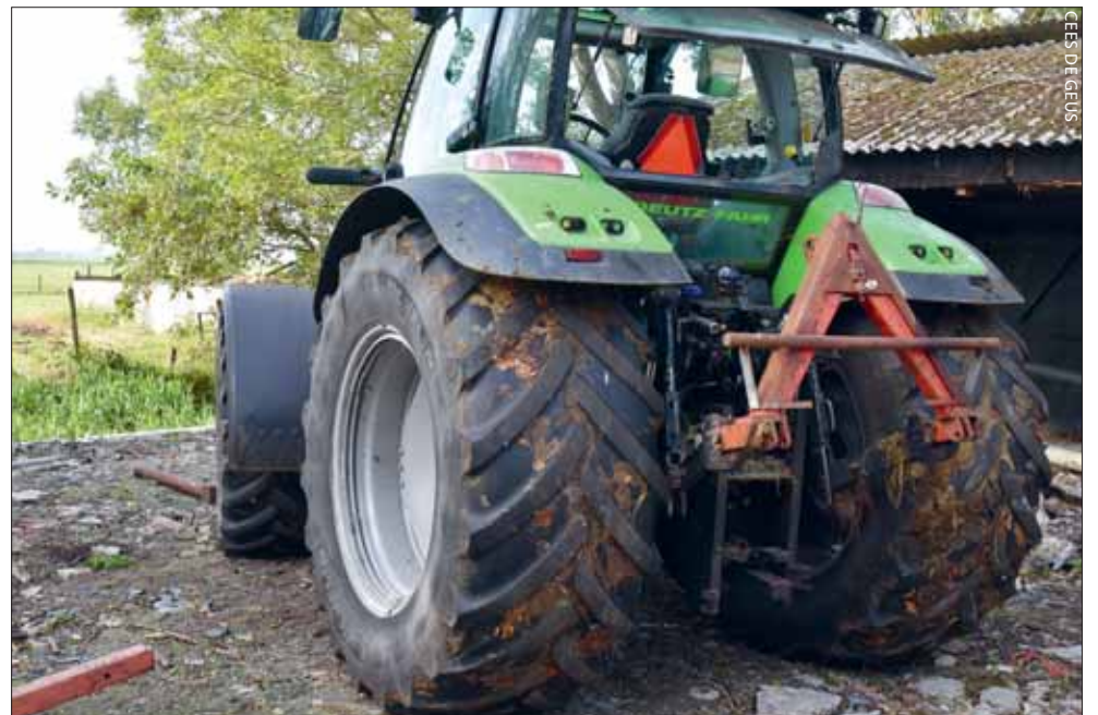
De brede banden met ondiep profiel ontzien de veengrond.
