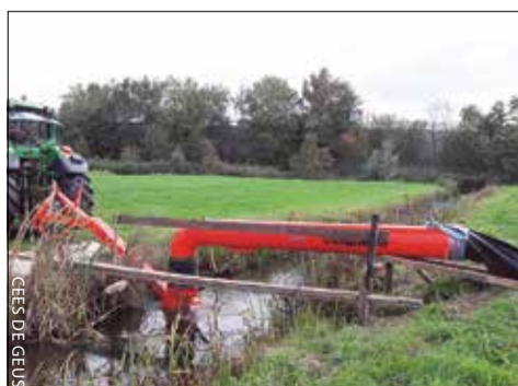
Het volpompen van het voormalig baggerdepot met een pomp die is aangesloten op de trekker.
