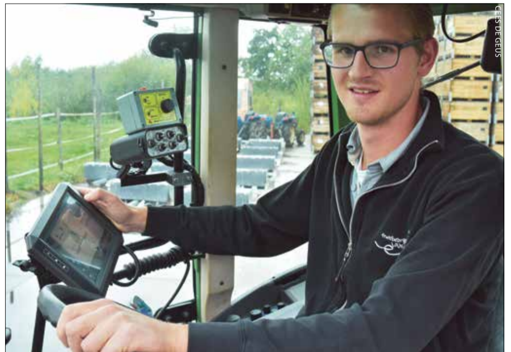
Met de display in de cabine van de spuittrekker kan Robin van Lint precies zien wat de spuitboom doet.
