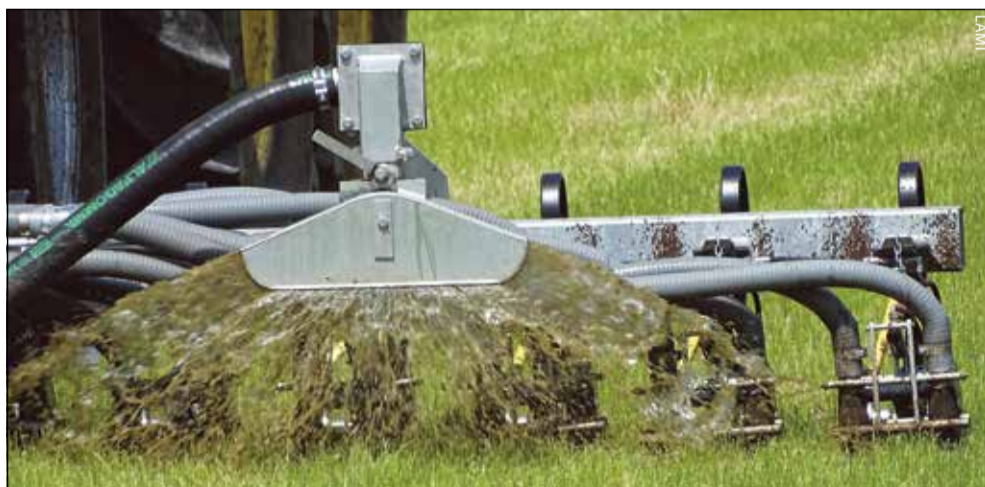
Water wordt aangebracht net nadat de sleufkouters de mest in de bodem hebben geïnjecteerd.
