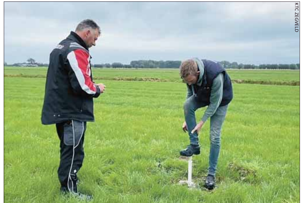
Op de Wijzer op veen-bedrijven worden de peilbuizen in de grond gestoken, waarna het meten van de grondwaterstanden kan beginnen.
