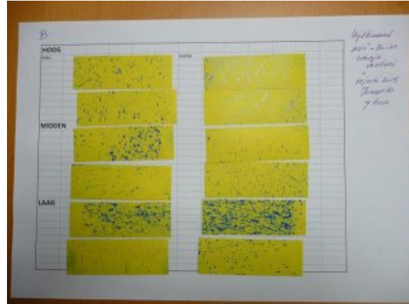
Afbeelding 5. Spuitbeeld op watergevoelig papier van de gebruikte spuitdooptypes op 11 juni 2015 laag, midden en bovenin de boom, links en rechts van de spuitmachine
