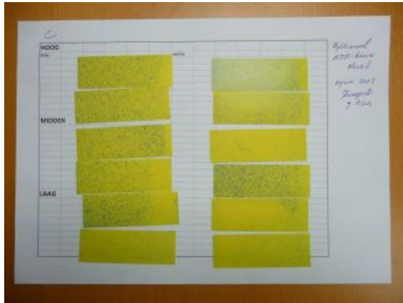
Afbeelding 5. Spuitbeeld op watergevoelig papier van de gebruikte spuitdooptypes op 11 juni 2015 laag, midden en bovenin de boom, links en rechts van de spuitmachine
