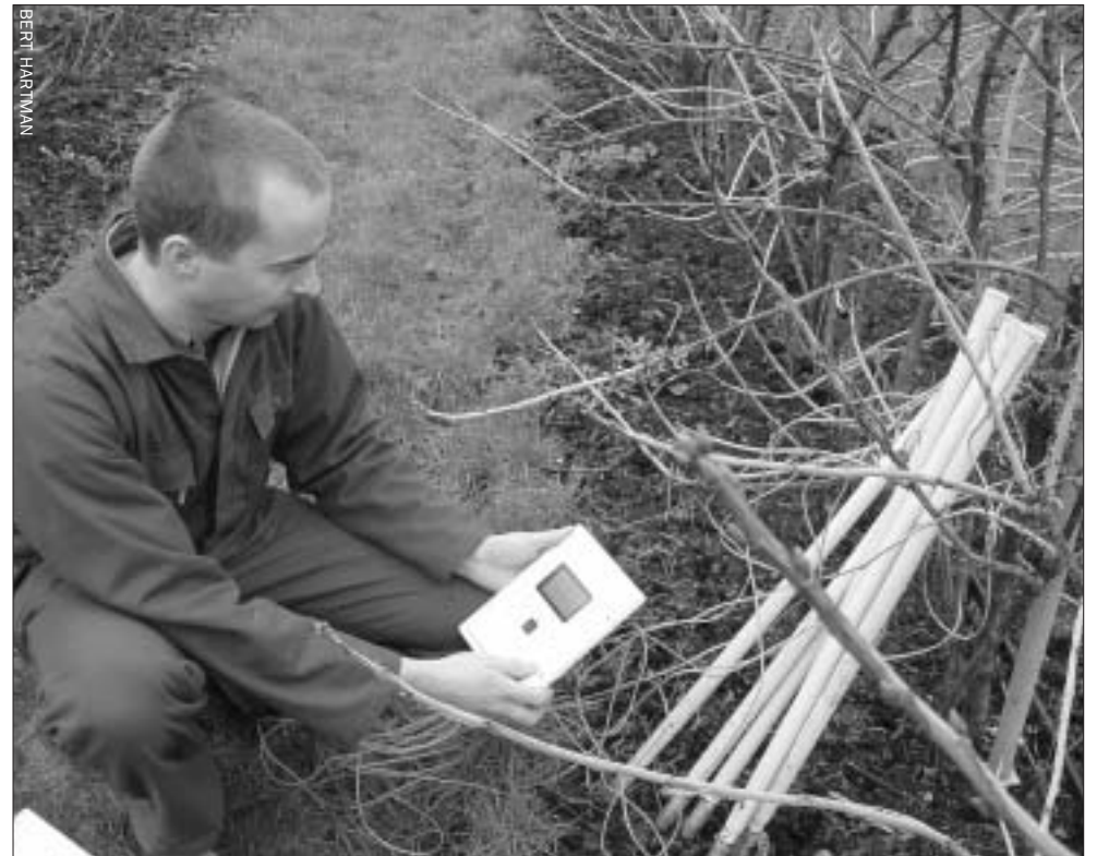
Met een zuigspanningsmeter krijgt Chris Miltenburg informatie over de vochtbehoefte van de grond. ‘De werkwijze geeft veel meer houvast.’
