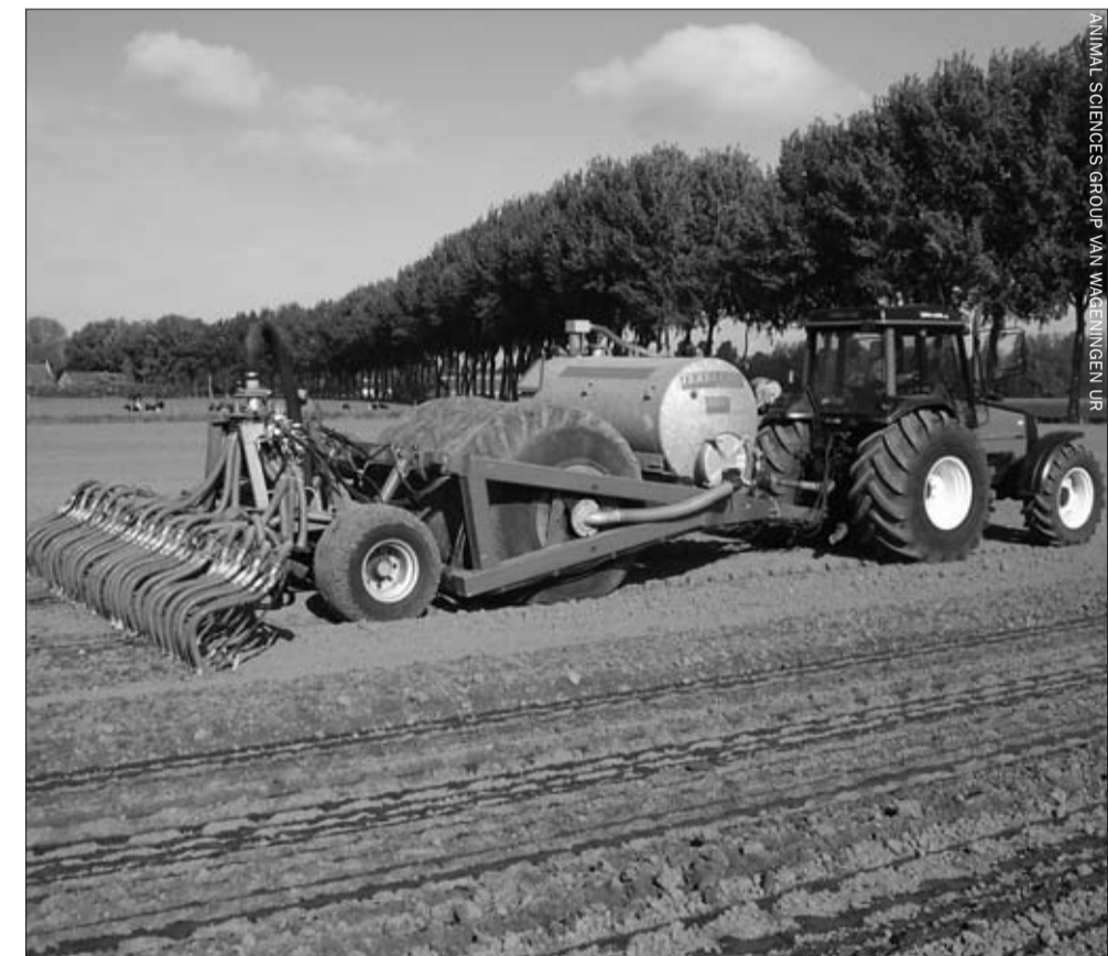
Op gronden die wat meer gevoelig zijn voor structuurbederf heeft de mestband een streepje voor op drijfmestrijdbemesting.
