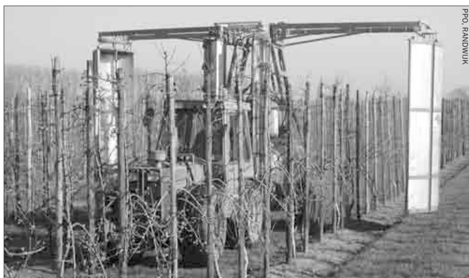
Het combineren van technieken, zoals spuit met reflectieschermen (foto) en venturidoppen geeft 95 procent emissiereductie.
