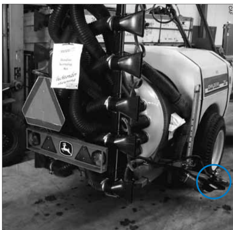
Voorbeeld van een extra spuitmond. Deze is schuin omhoog gericht om de onderkant van de takken goed te raken.
