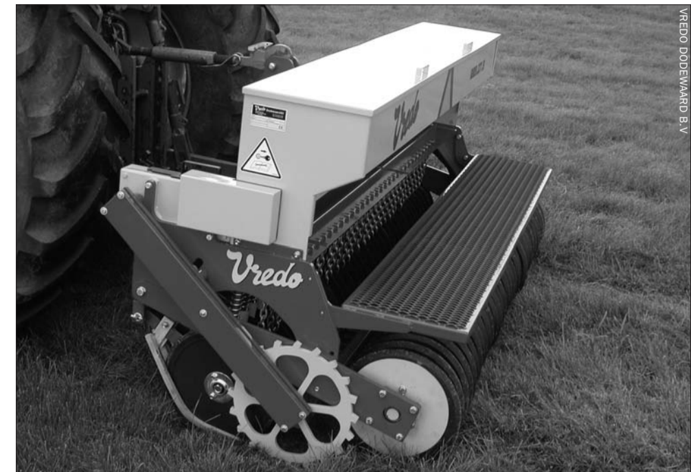
De Vredo-doorzaaimachine doet het vooral goed op zware kleigronden. Als het om de werksnelheid gaat, biedt de wiedege voordelen.
