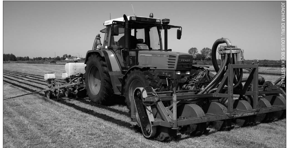
Vóór op de trekker staat de 6-rijige strokenfrees die 12 cm freest en drijfmest in de strook vermengt. De mesttoevoer gebeurt via een mesttank die ernaast rijdt. Achterop de trekker zaait de gewone maïszaaimachine in de gefreesde stroken.
