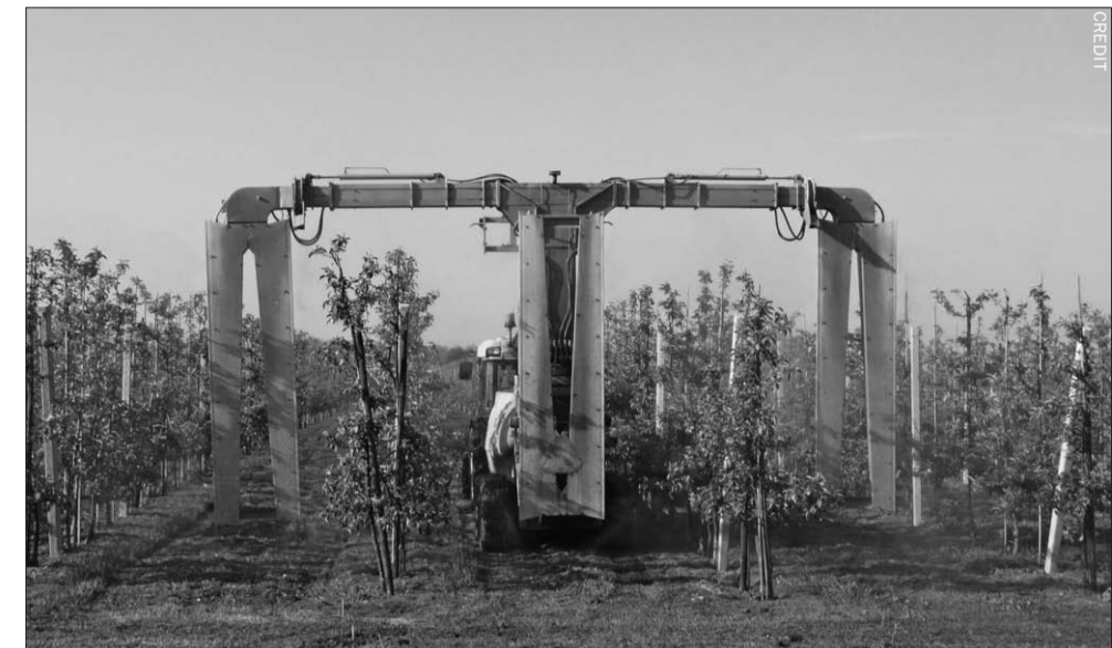
Henny Balkhoven (Fruitconsult): 'Het project heeft veel Utrechtse fruittelers kennis laten maken met de spuittechnieken van de toekomst.' Foto boven: De eerste onderzoeksresultaten met de 3-rijige spuittechniek zijn positief: driftreductie en tijdswinst. De aanschafkosten van de machine zijn echter hoog.
