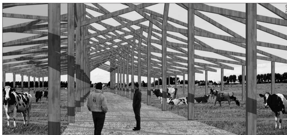
Impressie van de door Back McMaster Architecten ontworpen, uiterst transparante vrijloopstal met een houten skelet en een dak van een speciaal soort textiel dat veel licht doorlaat.
